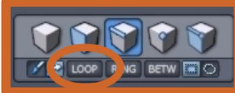
Nun wird die Kante durch anklicken des Icon rot gefärbt und kann verschoben werden. Weißes Dreieck anklicken mit der linken Maustaste festhalten und von der Kante nach außen ziehen.
