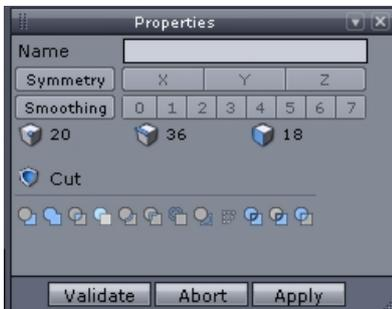
**37** Die Außenkanten werden markiert. Mit der Funktion „Line“/ „Curve extraction“ werden zwei gebogene Röhren erzeugt. Die Röhren werden markiert und unter der Funktion „Surface modling“/ „Cut“ wird die „Schablone“ neu geformt.
