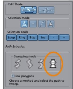
Im Vertex Menü „path sweep“ aufrufen und wie links im Bild Markiert das Symbol aktivieren. Anschließend auf die zuerst gezeichnete Kurve klicken.
