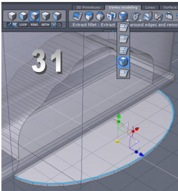
**32** Die Bogenkante der Frontseite ist nun zu markieren, um eine Kurve mit „Lines“/ „Curve extraction zu erzeugen. Diese Kurve wird im „Surface modeling“ Menü durch die Funktion „Thickness“ zu einem angepassten Zierelement für den Kamin.
